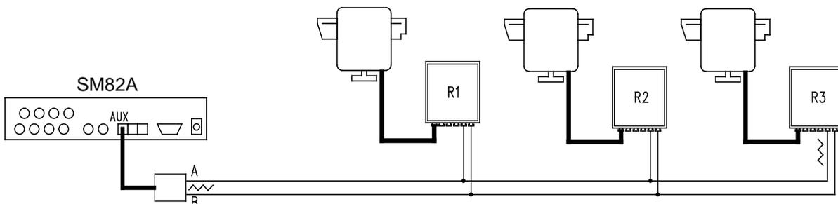
Bei den Empfängern R1, R2 darf der Abschlußwiderstand nicht eingeschaltet sein. Die Höchstlänge der Leitung von einem zum anderen Ende (von der AUX Umschalter- Leitung zum Empfänger R3) beträgt 1200 Meter.
