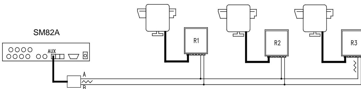
На приёмниках R1, R2 оконечное сопротивление не должно быть подключено. Максимальная длина линии, от одного конца до другого (от линии AUX до приёмника R3), составляет 1200 м.
