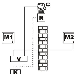
В этом примере клавиатура К непосредственно контролирует приемник R перемещения камеры С.
