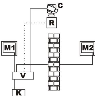
In diesem Beispiel ist M1 der *Master-Monitor*, M2 der *öffentliche Monitor*. Die Schwenk-Neige-Kamera C erfaßt den öffentlichen Monitor.
