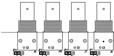
Пример: все входы с установленной нагрузкой 75 Ом
