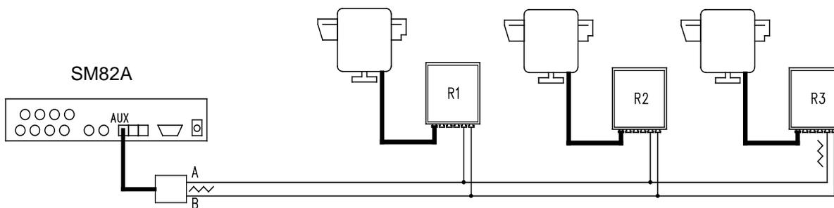
La résistance de terminaison des récepteurs R1, R2 ne doit pas être introduite. La longueur maximale de la ligne d'une extrémité à l'autre (de la ligne AUX matrice au récepteur R3) est de 1200 mètres.
