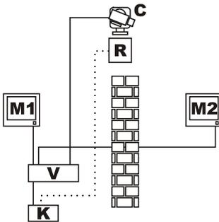
In diesem Beispiel steuert die Bedientastatur K direkt den Empfänger R, um die Kamera C zu bewegen.
