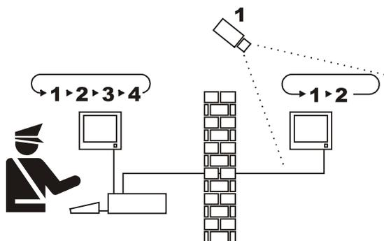
В примере, мастер-монитор показывает последовательность переключений на входах 1, 2, 3 и 4. На публичном мониторе отображаются входы 1 и 2. Телекамера 1 снимает зону с публичным монитором.
