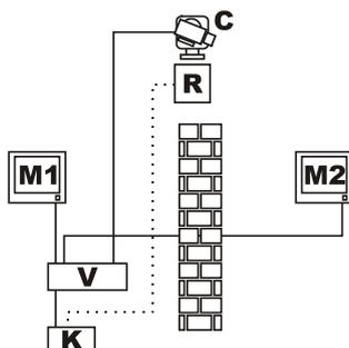
In questo esempio la tastiera K controlla direttamente il ricevitore R
