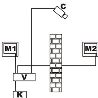
В этом примере M1 - *мастер-монитор*, M2 - *публичный монитор*. Фиксированная камера С показывает публичный монитор.
